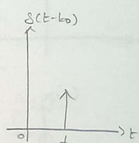
$$s(t) \xrightarrow{\text{F.T}} 1 \quad (\text{unit impulse}) \xrightarrow{\text{F.T}} \omega X$$
